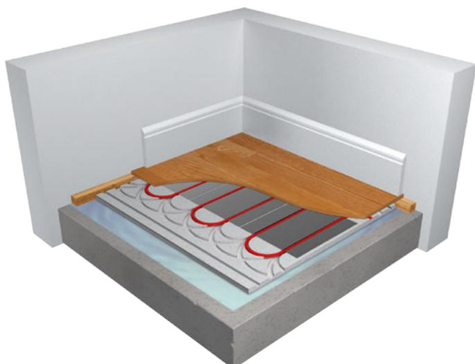
El sistema Warmup Total-16 es un sistema de aislamiento ligero, resistente y compuesto de tres componentes: placas rectas, placas de alimentación y placas de retorno. Estas placas están hechas en EPS de alta densidad, resistiendo hasta 40 toneladas de peso por metro cuadrado. Las placas rectas vienen con placas difusoras integradas. El Total-16 acelera de forma sustancial el tiempo de instalación para proyectos tanto de obra nueva como reforma, donde la altura del suelo sea escasa
