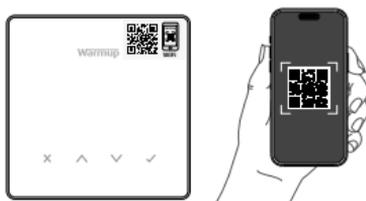
Escanea el código QR del protector de pantalla del termostato. Sigue las instrucciones de la app para completar la configuración.
