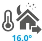
Ajustar la temperatura del sueño. La temperatura de retorno es una temperatura más baja de eficiencia energética cuando está fuera de un período de calefacción.
