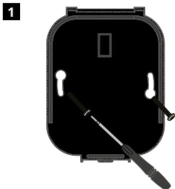
Introduzca los tornillos de fijación a través de los orificios de montaje de la base de potencia y apriételos.
