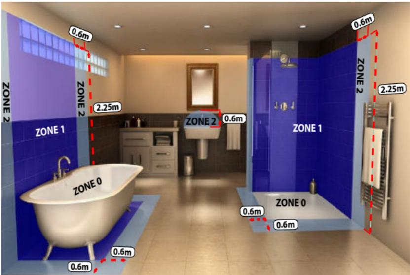
**NOTA:** En el caso de las instalaciones de baños, la normativa eléctrica prohíbe la instalación de productos de tensión de red como termostatos, contactores, derivaciones con fusibles, aisladores o cajas de conexión, dentro de las Zonas 0 o 1.
