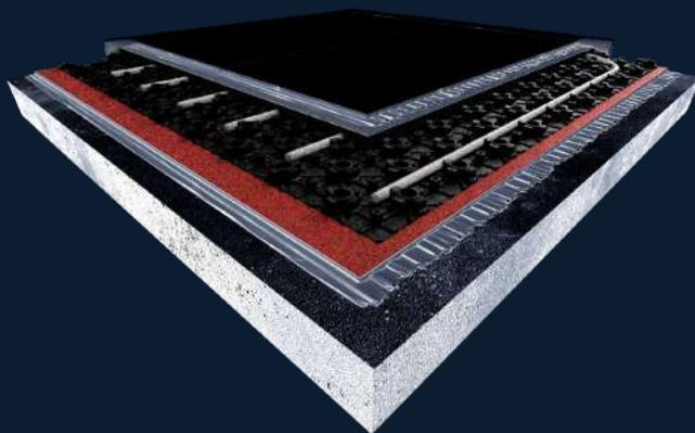
Rápido de instalar, sistema de suelo radiante con membrana autoadhesiva.
