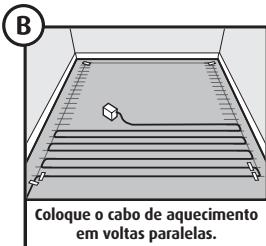
Coloque o cabo de aquecimento em voltas paralelas.
