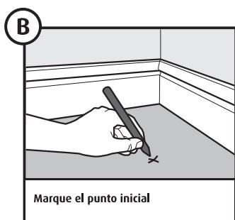
Marque los ángulos exteriores del área calentada respetando las distancias de perímetro extraídas anteriormente de la guía de dimensiones, y una los ángulos para formar un perímetro exterior marcado.
