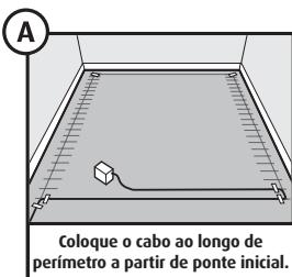
Coloque o cabo ao longo de perímetro a partir de ponte inicial.
