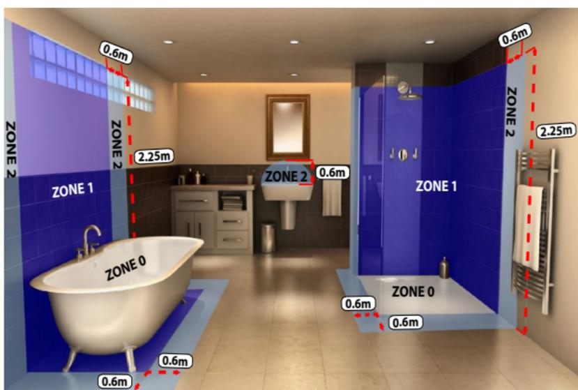
**NOTA:** En el caso de instalaciones en baños, las regulaciones eléctricas prohíben la instalación de productos con tensión de red como termostatos, contactores, cajas de conexiones, dentro de las zonas 0 o 1.
