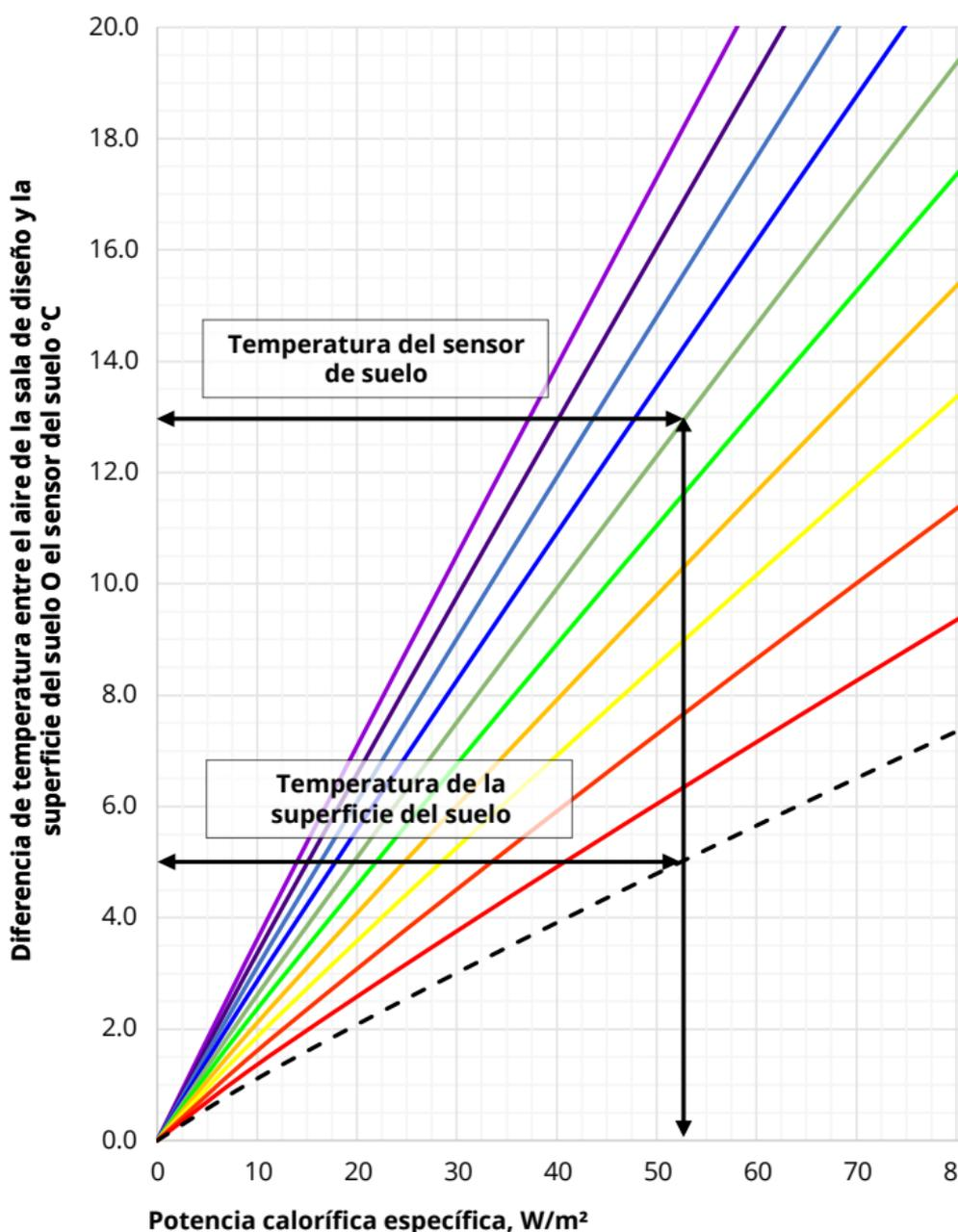
Utilizando el gráfico anterior, es posible obtener la potencia calorífica específica de un sistema de calefacción por suelo radiante eléctrico en función de la diferencia de temperatura entre la temperatura del aire de la habitación de diseño y la temperatura de la superficie del suelo o del sensor del suelo según el acabado del mismo.
