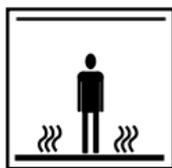
El cableado eléctrico y los paneles de calefacción contenidos en el suelo. NO penetre con clavos, tornillos o dispositivos similares. NO restringir la emisión térmica del suelo radiante.
