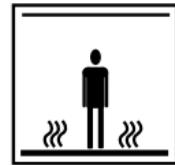
Las unidades calefactoras de láminas flexibles se instalan dentro del suelo. NO penetrar con clavos, tornillos o dispositivos similares. NO restrinja la emisión térmica del suelo calefactado. NO coloque materiales distintos de los recomendados
