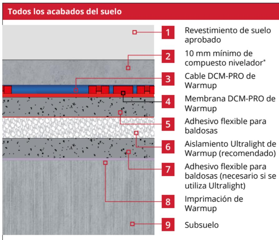
\* Este método puede utilizarse para crear una superficie de suelo adecuada para la mayoría de los acabados de suelo y al formar una pendiente de drenaje dentro de un cuarto húmedo. El compuesto de nivelación, cuando utilizado, debe aplicarse como una sola capa. Las capas adicionales de compuesto de nivelación deben no se puede añadir. Compruebe con el fabricante del suelo su idoneidad con la calefacción por suelo radiante.
