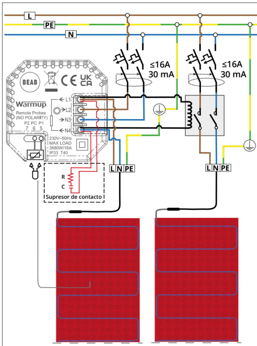
Los termostatos de Warmup tienen una capacidad máxima de 16 amperios (3680 W a 230 V). Debe utilizarse un contactor para conmutar las cargas que superen los 16 amperios.
