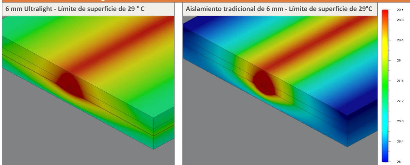
Figura. 1 - Difusión de calor mejorada con el aislamiento Ultralight frente al tradicional
