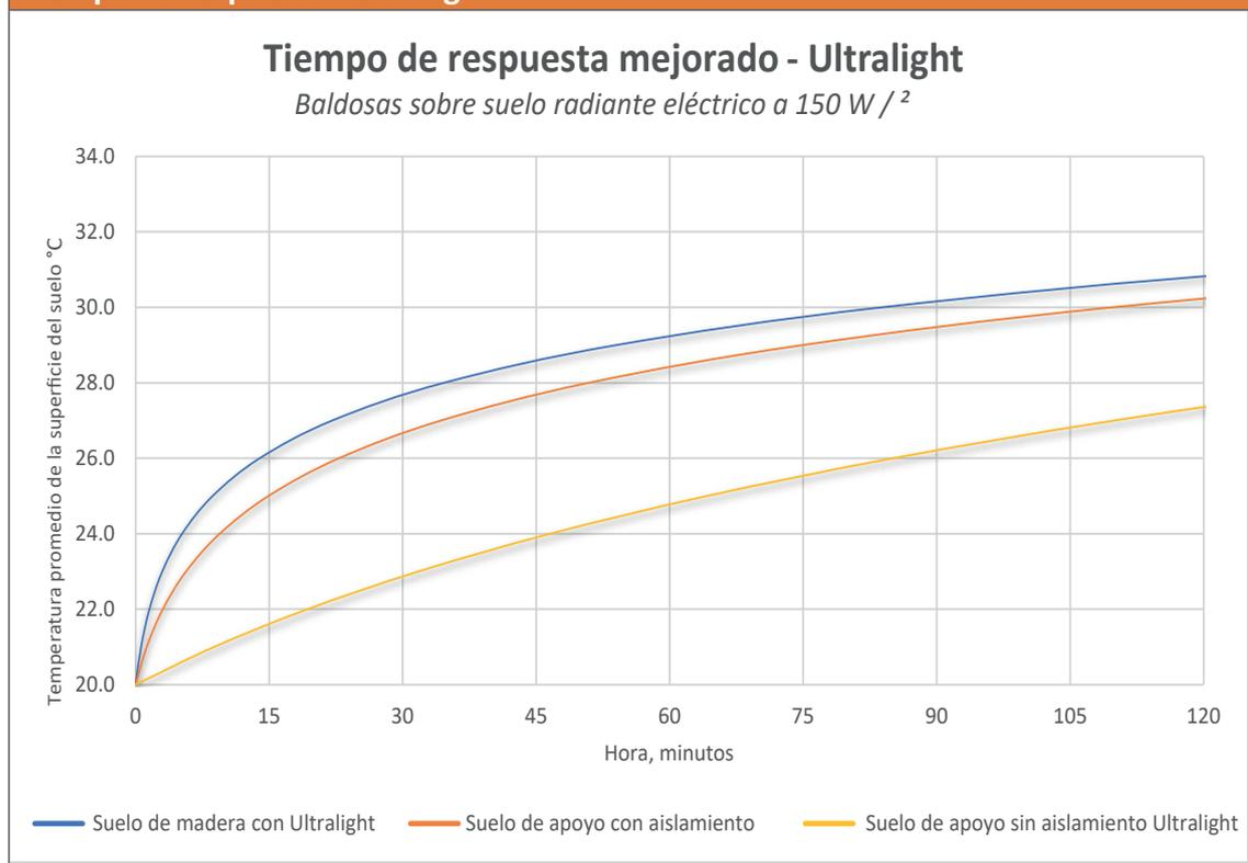
Figura. 2 - Mejora en el tiempo de respuesta debido al uso de Ultralight
