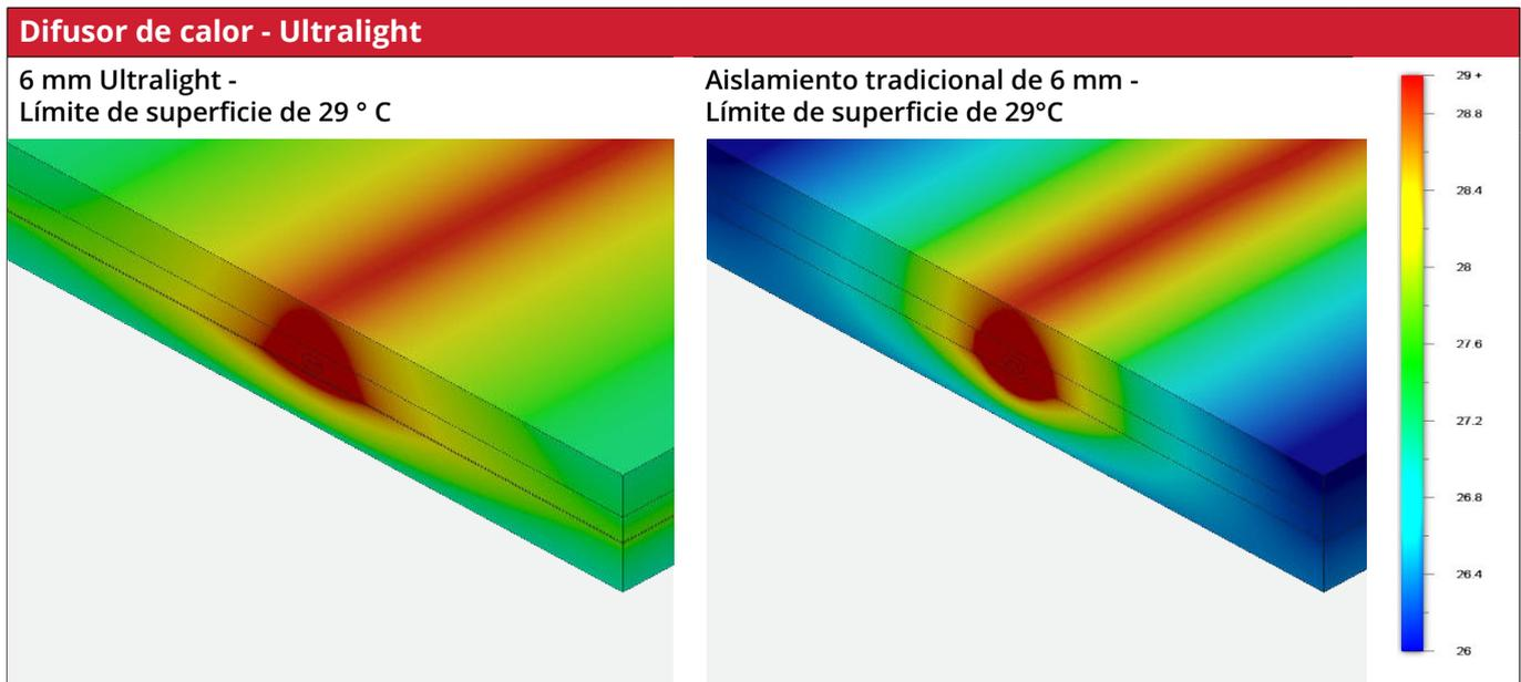
**Figura. 1 - Difusión de calor mejorada con el aislamiento Ultralight frente al tradicional**
