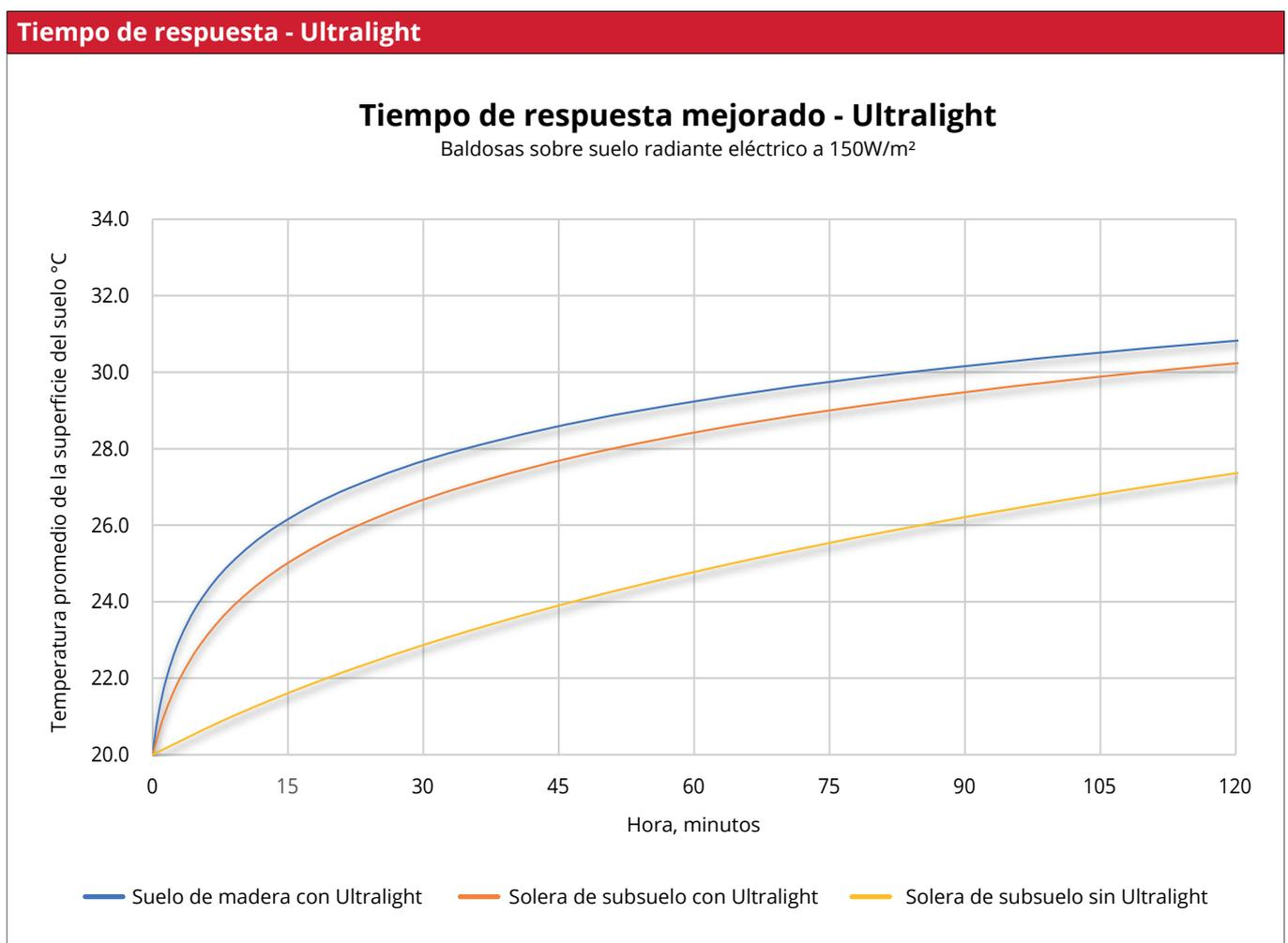
**Figura. 2 - Mejora en el tiempo de respuesta debido al uso de Ultralight**
